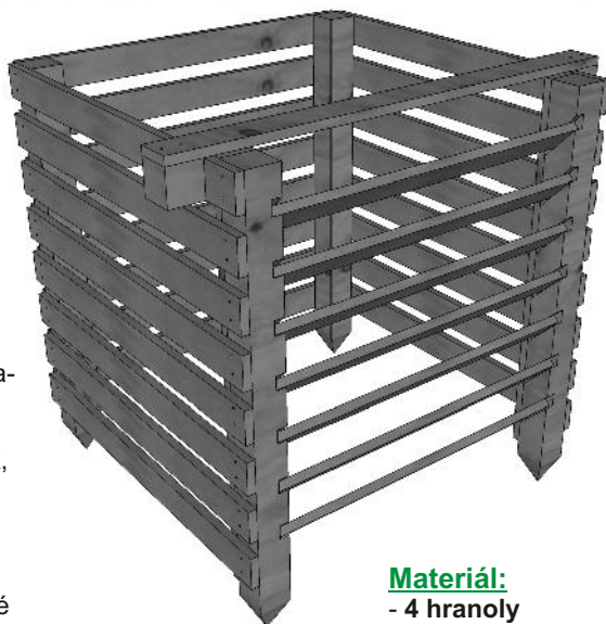
Obr. 1: Nákres zárezu do predného stĺpu zásobníka
